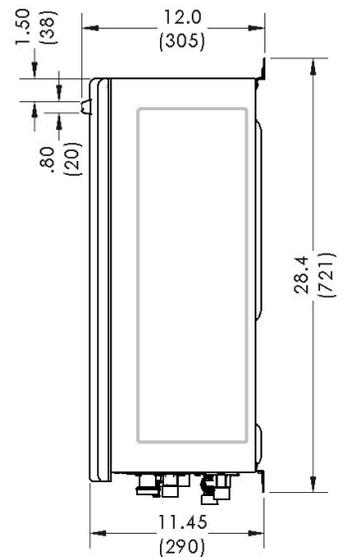
Figure 5: Dimensions des modèles extérieurs
