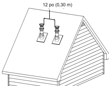
Figure 25: Entre plusieurs extrémités au même niveau
