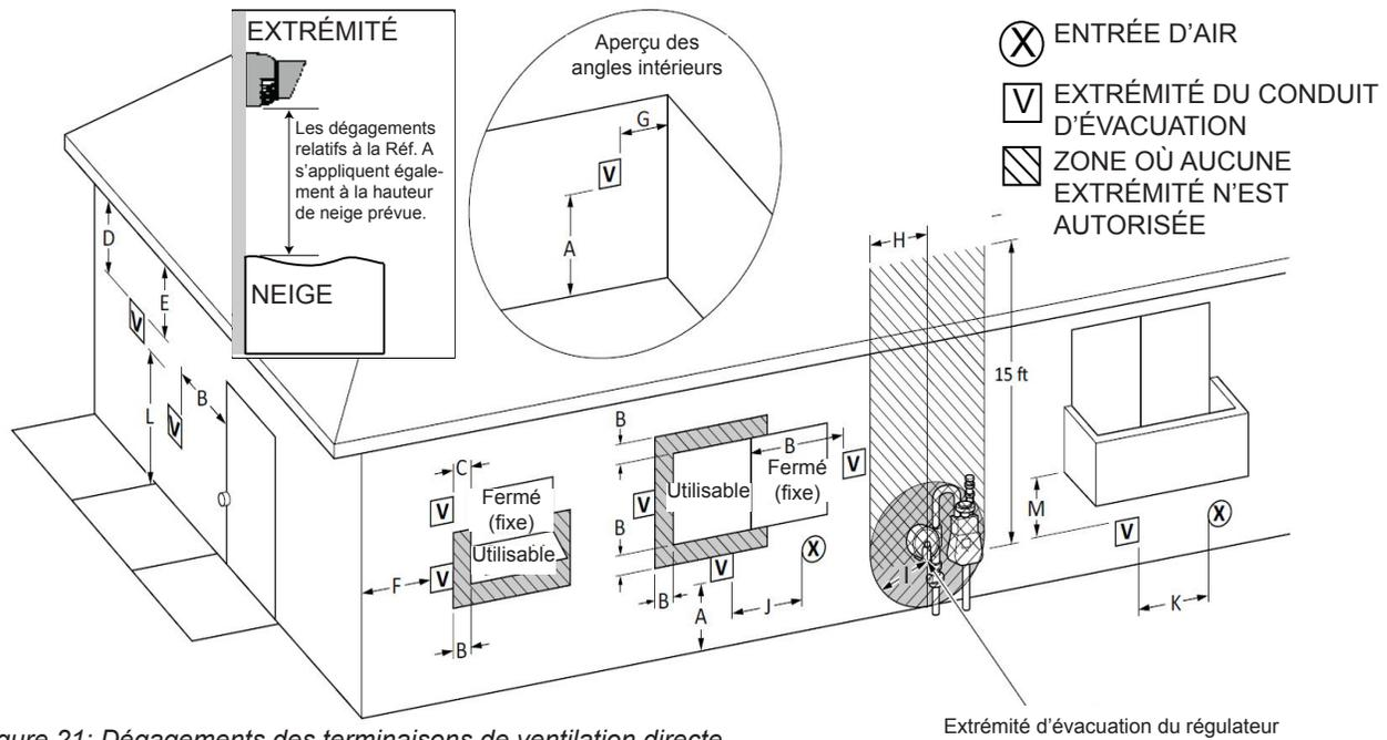
Figure 21: Dégagements des terminaisons de ventilation directe
