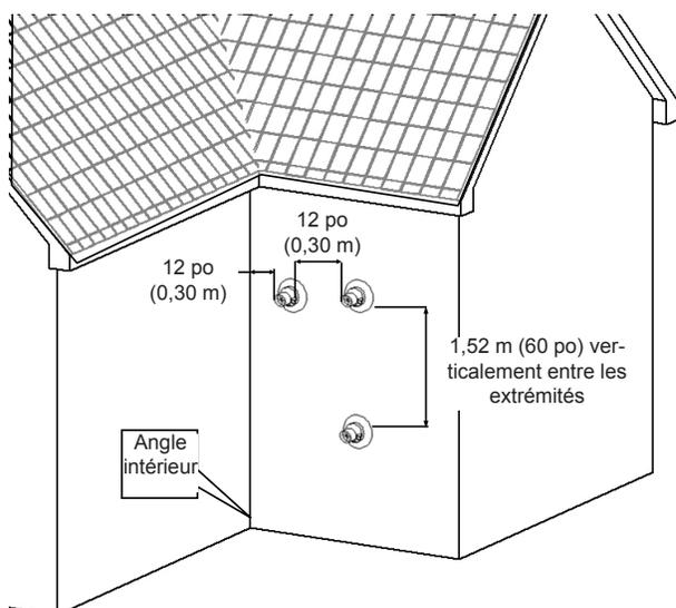
Figure 22: Dégagements des terminaisons de conduit concentrique
