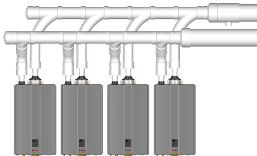
Figure 48: Exemple: Circuit commun d'évacuation PVC/CPVC Série 40
