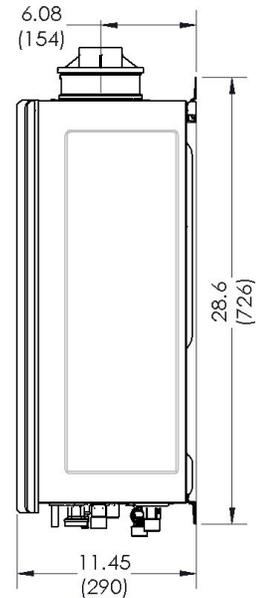
Figure 4: Dimensions des modèles intérieurs
