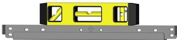
Figure 9: Installer le support à niveau
