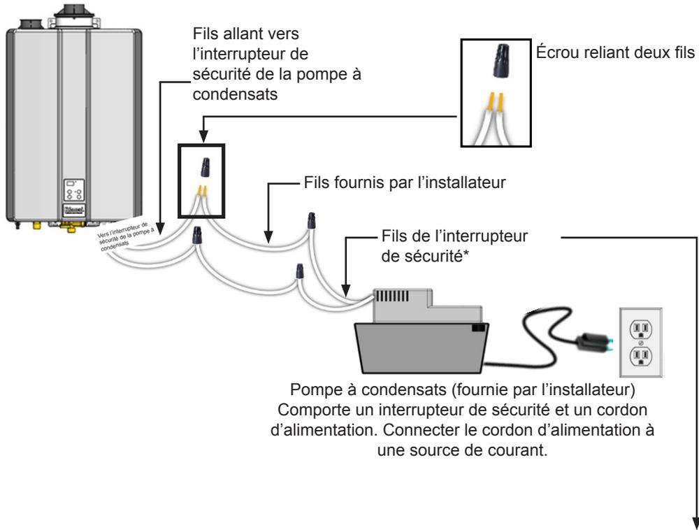
\* Les fils de l'interrupteur de sécurité se branchent aux contacts NO et COM de l'interrupteur de sécurité.
