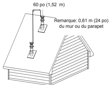
Figure 24: Entre plusieurs extrémités à différents niveaux
